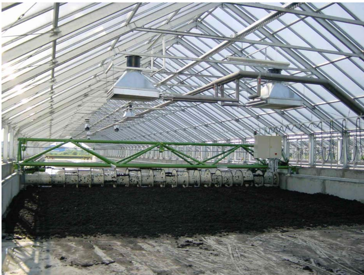
Zdjęcie 5: Rozgarnianie i przewracanie osadu przewracarką WENDEWOLF®
