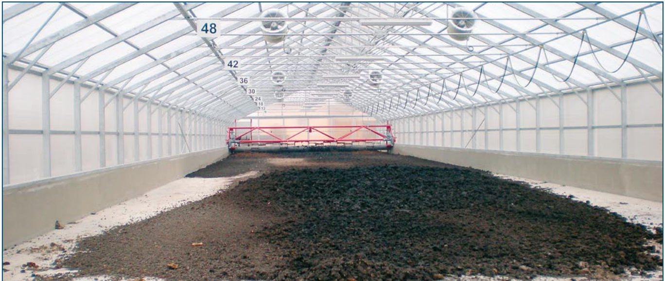
Fot. 3. Hala suszarni słonecznej w Kozienicach
